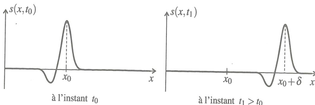
Entre les instants  $t_0$  et  $t_1$ , l'onde qui progresse dans le sens positif de l'axe  $(Ox)$  se déplace d'une distance  $\delta$ . Ainsi la valeur observée à l'instant  $t_0$  en  $x$  est observée à l'instant  $t_1$  en  $x + \delta$  :
